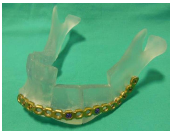
图8 打印下颌骨重建三维模型，预弯制个性化重建钛板
